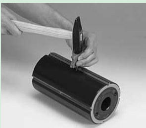
Tap the setting jig gently Spannkeil leicht anschlagen
