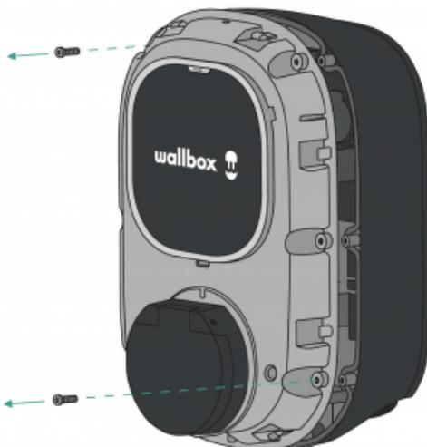
6. Retirez les deux vis d'angle et soulevez le couvercle avec précaution.
