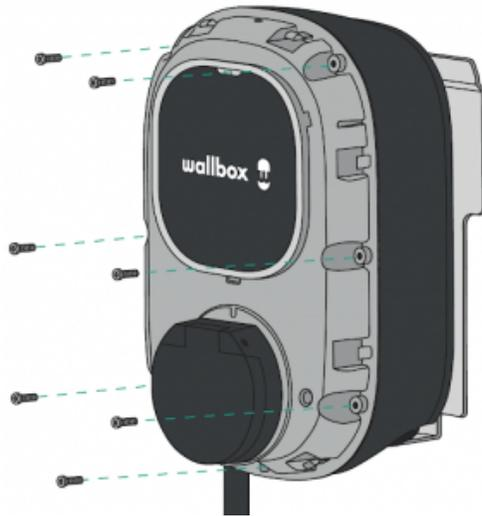
2. Insérer sept vis d'angle pour fixer le couvercle du chargeur. Ne pas trop serrer.
