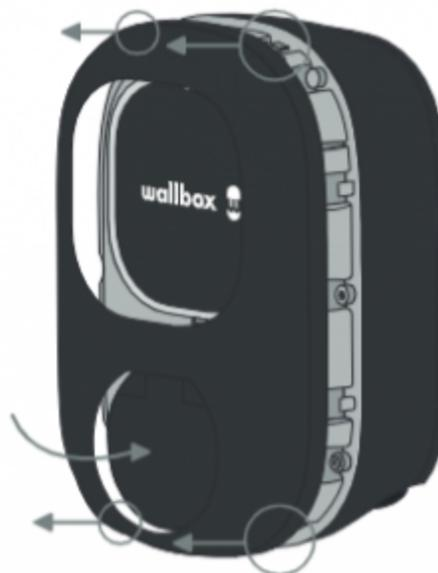
5. Déclipser le couvercle de style en appuyant avec précaution sur le couvercle de la prise avec les doigts.
