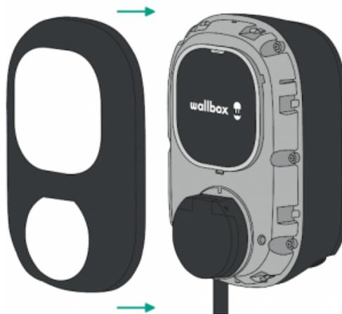
3. Clipsez le cadre du couvercle sur le chargeur et fixez-le à l'aide de l'autre vis de sécurité. Ne pas trop serrer.
