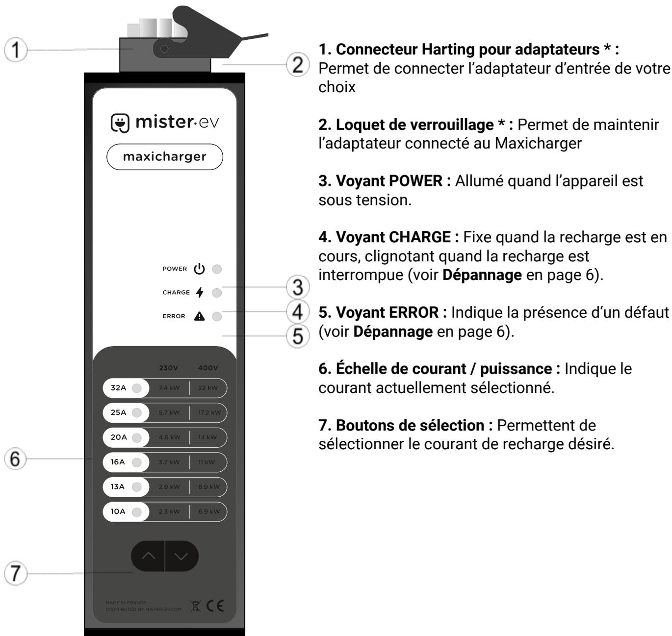
**1. Connecteur Harting pour adaptateurs \*** : Permet de connecter l'adaptateur d'entrée de votre choix
