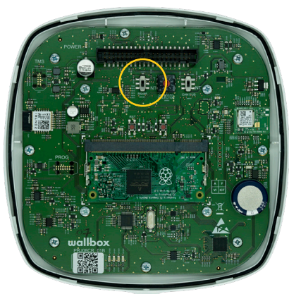
Fig. A3.1 Réglage du commutateur RS485 sur « T »
