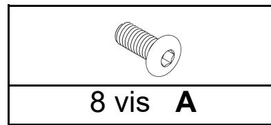
1.1 Fixez la base à l'aide des 8 vis (A) et de la clé Allen de 4 mm.
