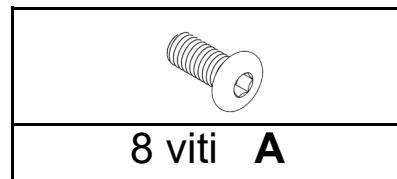
1.1 Fissare la base utilizzando le 8 viti (A) e la chiave a brugola da 4 mm.
