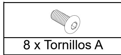
1.1 Fije la base con los 8 tornillos (A) y la llave Allen de 4mm
