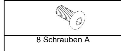
1.1 Befestigen Sie den Sockel mit den 8 Schrauben (A) und dem 4 mm Inbusschlüssel
