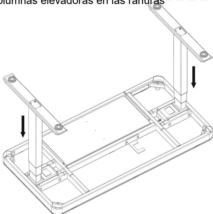
2.2 Apriete los 8 tornillos preinstalados (E) para fijar las columnas de elevación al tablero
