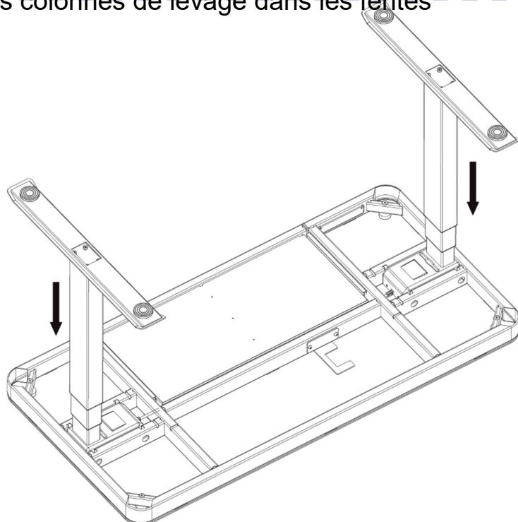
2.2 Serrez les 8 vis préinstallées (E) pour fixer les colonnes de levage au plateau de la table.
