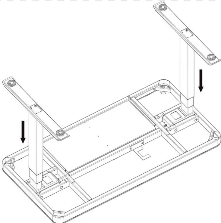
2.2 Ziehen Sie die 8 vorinstallierten Schrauben (E) an, um die Hubsäulen an der Tischplatte zu befestigen.
