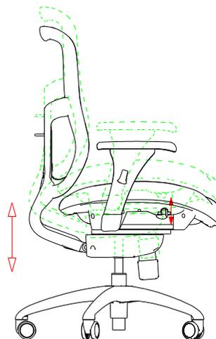
**3) Réglage de la profondeur siège**
