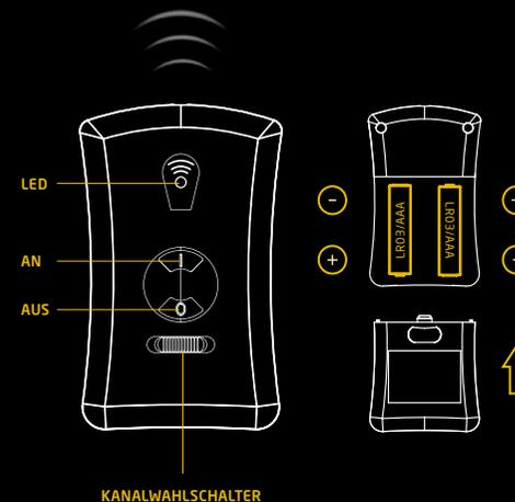
Eine zuvor gemachte Zuordnung zu einem Kanal machen Sie rückgängig indem Sie die betreffenden Leuchtelemente neu initialisieren. Dazu muss der Batteriekontakt einmal unterbrochen werden (Batteriefach öffnen / wieder schließen). Die LED leuchtet dann. Danach können Sie einen anderen Kanal einstellen und die Kerzen, wie oben beschrieben, bedienen.
