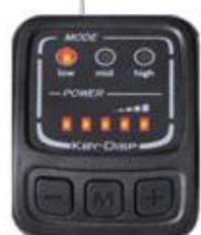
1.1 Um das Elektrofahrradsystem ein- oder auszuschalten, halten Sie die Taste 2 Sekunden lang gedrückt. Der Standardwert des Systems ist „low“. (die Niedriggeschwindigkeit)
