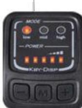
Pour allumer/éteindre le système du vélo électrique, appuyez sur le bouton pendant 2 secondes, la valeur par défaut du système est « basse » faible vitesse. Fonction électrique complète (mode électrique pur + mode d'assistance))
