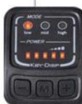
Mantenga presionado el botón durante 2 segundos para encender / apagar el sistema E-Bike. El valor predeterminado es el nivel de asistencia al pedal "bajo". Función eléctrica completa (modo eléctrico puro)
