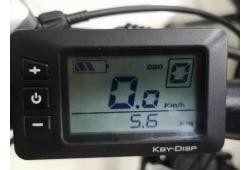
Mantenga presionado el botón durante 2 segundos para encender / apagar el sistema E-Bike. El valor predeterminado es el nivel de asistencia al pedal "1". (modo eléctrico puro + modo de asistencia)
