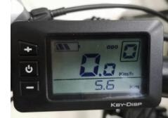
Tenere premuto il pulsante per 2 secondi per accendere / spegnere il sistema E-Bike. Il valore predefinito è il livello di pedalata assistita "1". (Modalità elettrica pura + modalità di assistenza)
