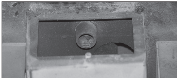
Figure 35 : Éliminer les cendres de tube d'allumeur (sous la boîte à feu)
