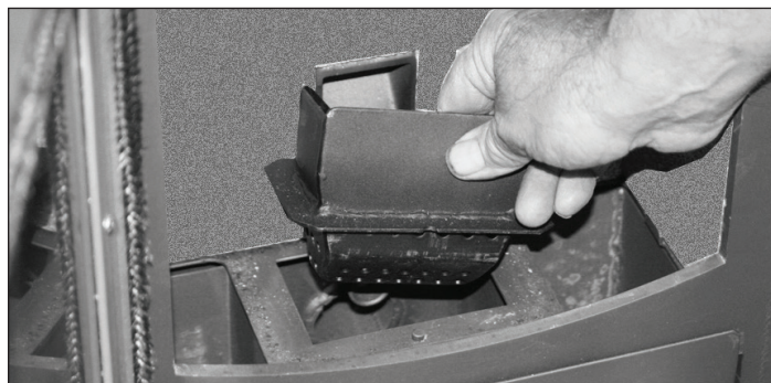
Figure 30 : Nettoyage de la boîte à feu
