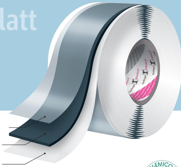
Gerband 605.25 ist ein sehr klebstarkes und hochdehnfähiges PE-Butyl-Dichtband von dauerhafter Wasserbeständigkeit und sehr hoher Alterungsbeständigkeit. Es wird zum Abdichten von Luftdichtheitsschichten im Dach- und Hochbaubereich gemäß DIN 4108-7 verwendet.
