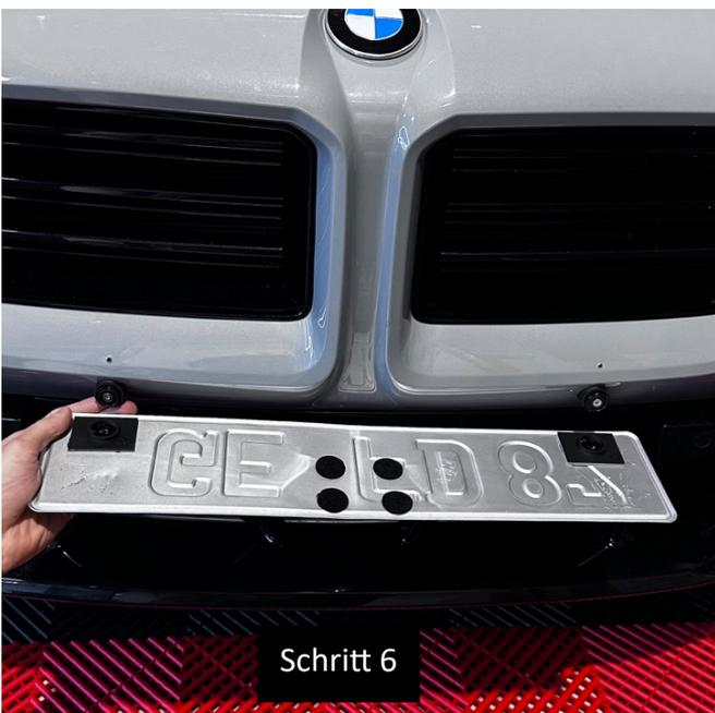
1. Halter mit den mitgelieferten Schrauben am Fahrzeug montieren.
