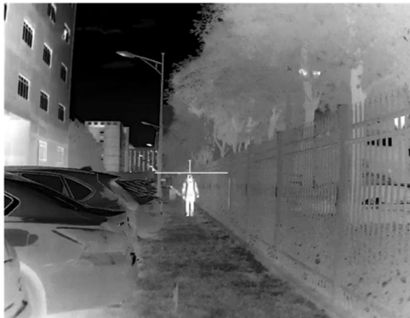
Abbildung 4-1 Einstellen der Kante der Zieloberseite
