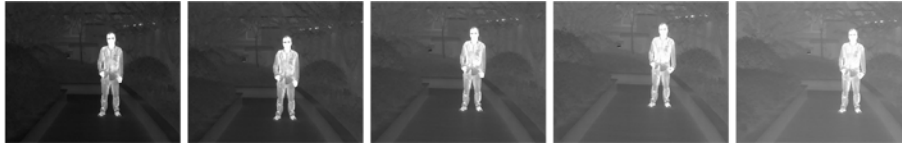
Abbildung 3-4 Einstellen der Helligkeit im Modus „Weißglühend“
