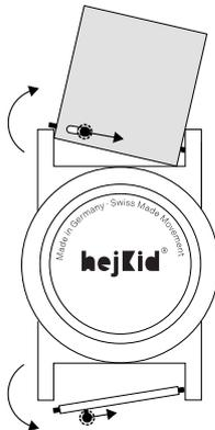
Genauso lässt sich der kleine Metallstift lösen, der den anderen Teil des Armbands auf der anderen Seite des Gehäuses entlangführt.
