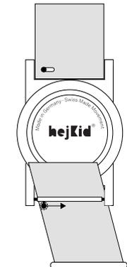
Befestige zunächst den Teil des Armbands mit integriertem Metallstift. Du kannst frei wählen auf welcher Seite des Gehäuses. Schiebe den Metallstift wieder nach innen und lasse das neue Band einrasten.
