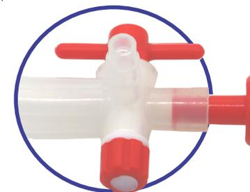
Desecador de plástico para vacío con tapa de botón, base y tapa fabricada en policarbonato .
