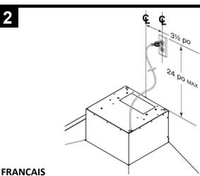
2. Installer la prise dans l'espace qui sera couvert par le conduit décoratif. S'assurer qu'elle n'interfère pas avec l'emplacement de fixation d'un support de montage ou avec le conduit décoratif. Cet appareil doit être relié à une mise à la terre.
