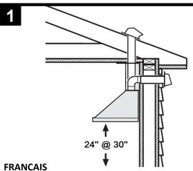
I. Installer des conduits de dimensions adéquates, des coudes et un capuchon de toit ou de mur selon le type d'installation choisi. La distance minimale entre le bas de la hotte et la surface de cuisson est de 24 po (30 po au-dessus d'une cuisinière à gaz).
