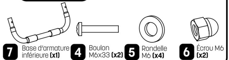
Placez la partie inférieure de l'armature de l'échelle sous la partie supérieure de l'échelle assemblée (7) en vous assurant d'aligner les trous de boulon. Insérez un M6x33 boulon (4) avec une rondelle A M6 (5) de chaque côté de l'armature de l'échelle. Serrez avec un écrou M6 (6) de chaque côté.
