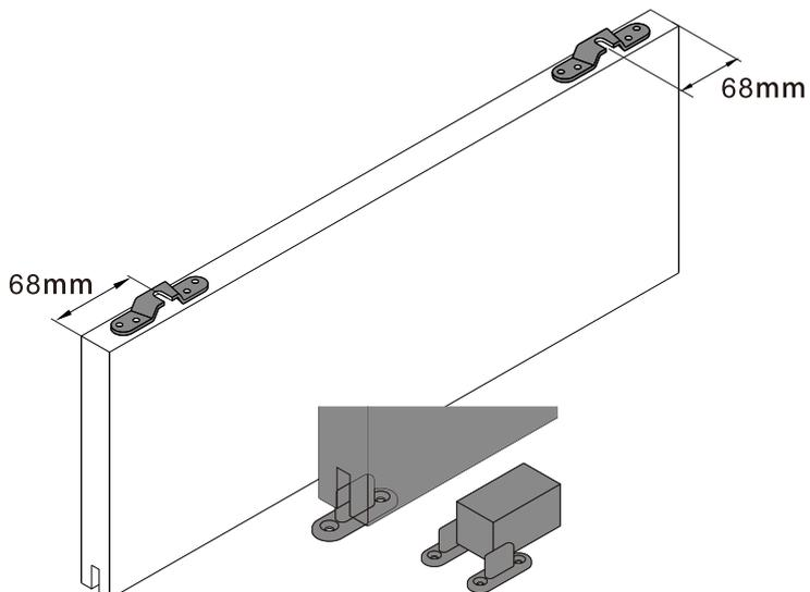
Ejemplos de instalación de la guía inferior.
