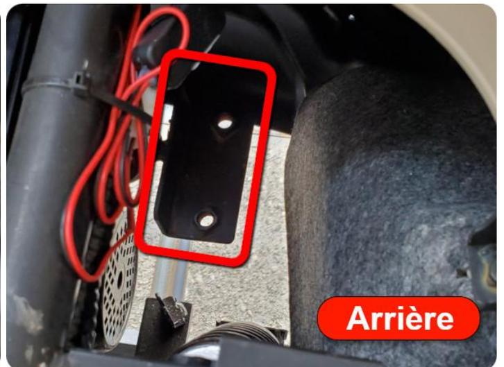
Avec de l'aide, alignez le pare-chocs sous les plaques de montage et alignez les trous du pare-chocs avec les trous de la plaque de montage. Boulonner vers le haut dans l'écrou soudé dans la plaque de montage, 2 boulons par côté, 4 par pare-chocs.
