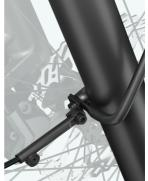
Connectez le phare avant et attachez les câbles avec les clips de câble fournis avec le porte-bagages avant. Ajustez l'angle du porte-bagages avant, puis serrez les vis qui ont été pré-serrées précédemment aux étapes l et 4.
