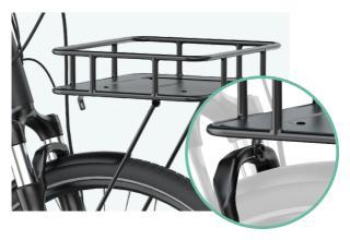
Remarque : ne serrez pas les vis à fond tant que l'ensemble du porte-bagages avant n'est pas positionné à sa place à l'étape 7.
