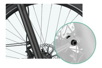
Remettez en place le support de garde-boue d'origine et les vis de fixation de la fourche avant à l'aide des vis fournies avec le porte-bagages avant. Fixez le support du porte-bagages avant et le bloc de serrage à l'aide d'un tournevis cruciforme comme illustré sur le schéma, puis serrez les vis sur le support du garde-boue avec une clé hexagonale n° 4.
