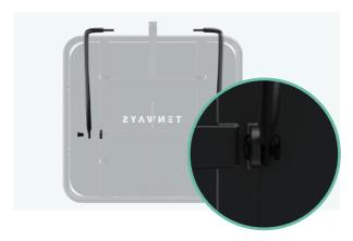
Remarque : ne serrez pas les vis à fond tant que l'ensemble du support avant n'est pas positionné à sa place et que l'angle d'installation n'a pas été correctement ajusté à l'étape 7.
