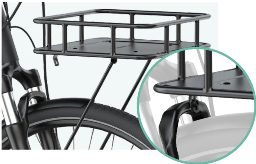
**Nota:** No aprietes los tornillos totalmente hasta que el soporte delantero no haya quedado correctamente instalado en su lugar según el paso 7.
