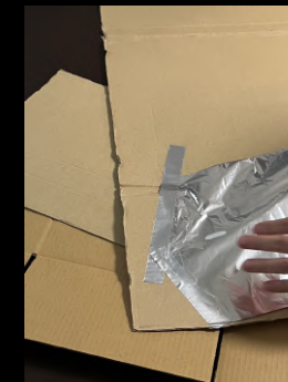
④アルミテープで仮止め
