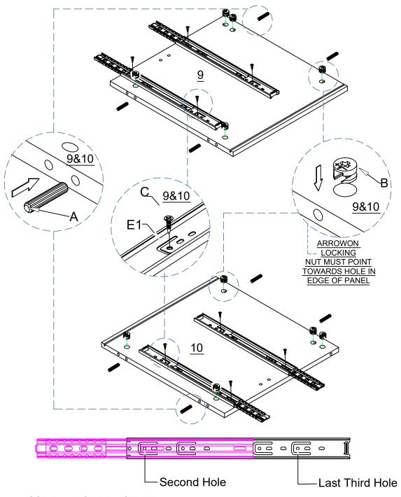
SCREW MUST BE INSERTED IN THE SECOND HOLE ON THE DRAWER RUNNER
