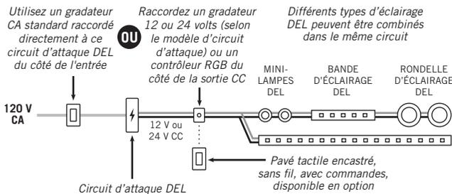
**Ne combinez jamais un gradateur 120 volts CA, un gradateur 12/24 volts CC ou un contrôleur RVB dans le même circuit. Il est permis d'utiliser un commutateur marche/arrêt mural standard avec un gradateur ou un contrôleur 12/24 volts.**
