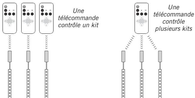
**REMARQUE :** Les effets lumineux ne restent pas synchronisés lorsqu'une télécommande est réglée pour contrôler plusieurs kits.
