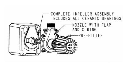
1½" INSIDE DIAMETER IS THE MINIMUM HOSE SIZE THAT SHOULD BE USED FOR MAXIMUM FLOW
