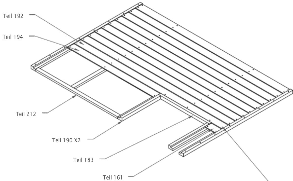
Wenn alle Teile bündig mit der Platte und den Rahmen sind, befestigen Sie sie mit #8 x 1,00 Zoll Holzschraube X28
