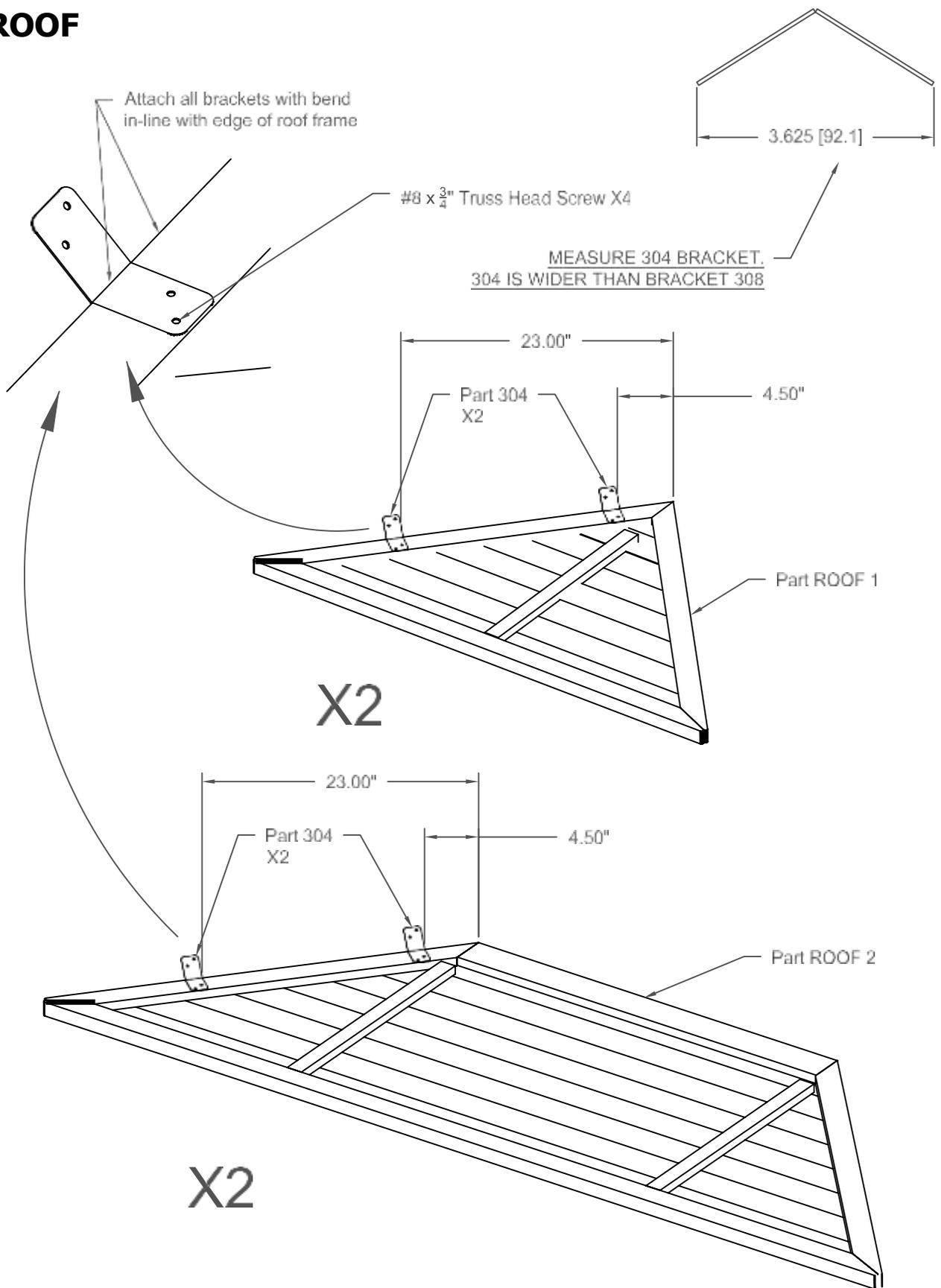
1. Befestigen Sie die (2) Halterungen wie abgebildet an einem Dachabschnitt.
