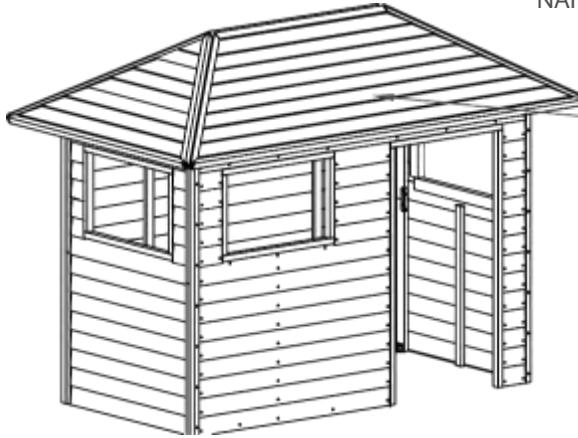
Zwei Menschen erforderlich für Heben Sie die Dachbaugruppe an und setzen Sie sie auf die Hütte.
