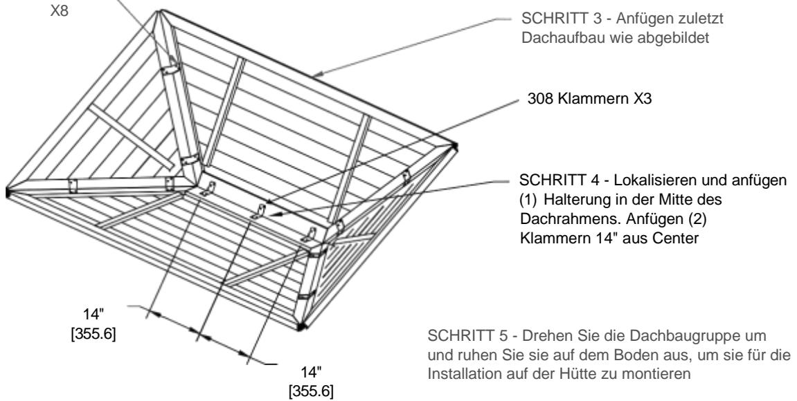
SCHRITT 5 - Drehen Sie die Dachbaugruppe um und ruhen Sie sie auf dem Boden aus, um sie für die Installation auf der Hütte zu montieren
