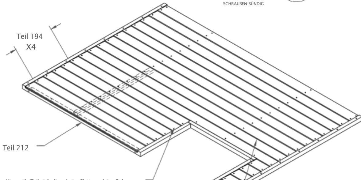
Wenn alle Teile bündig mit der Platte und den Rahmen sind, befestigen Sie sie mit #8 x 1,00 Zoll Holzschraube X21
