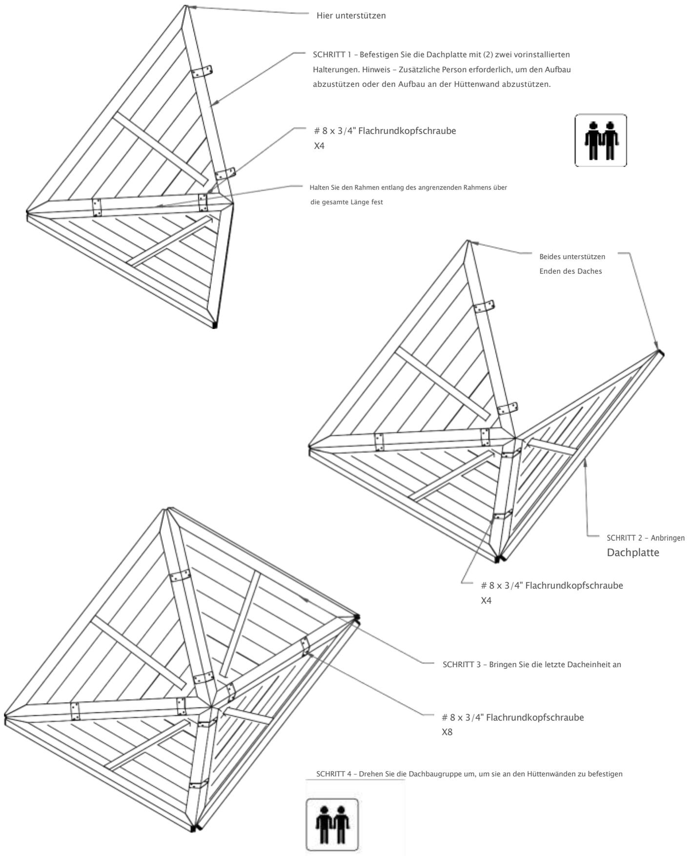
1. Dachpaneele wie abgebildet montieren.
