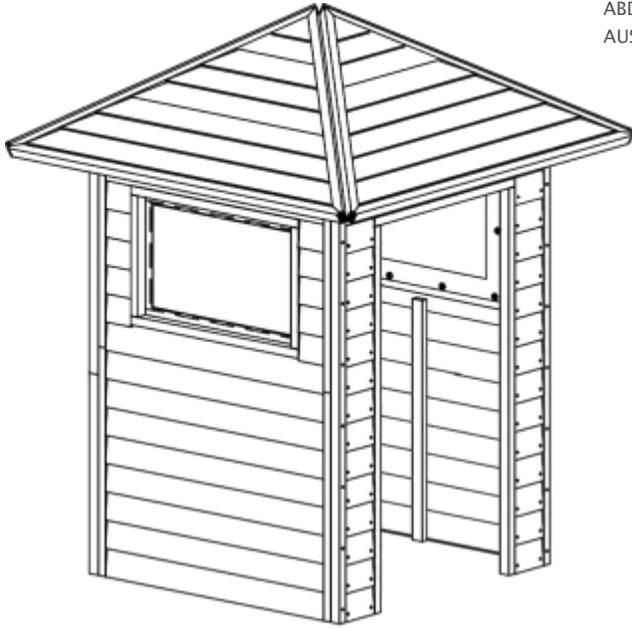
Zum Anheben und Aufsetzen der Dachbaugruppe auf die Hütte sind zwei Personen erforderlich. Das Dach wird auf den Ecken der Hütte ruhen
