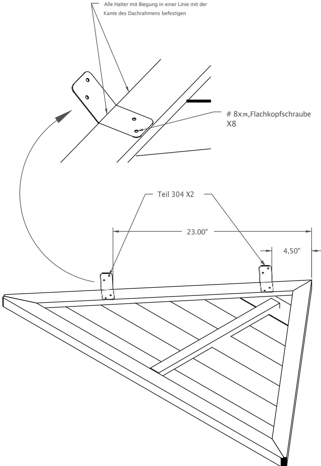
**BEFESTIGEN SIE DIE HALTERUNG AN DEN X4 DACHPLATTEN**
