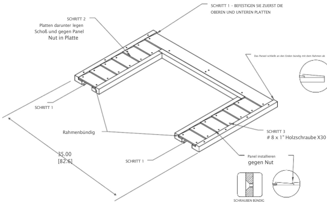
1. Teile wie abgebildet anordnen und ausrichten.
