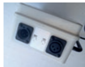
Trasformatore a 2 uscite. Dual power transformer.
