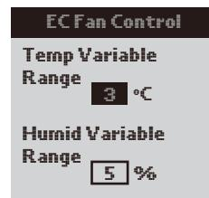
Inoltre, impostare il CAMPO VARIABILE REGOLABILE per la temperatura e l'umidità nella scheda Impostazioni ventilatore EC. Quando i parametri impostati vengono superati, lo scarico inizierà a funzionare alla velocità massima impostata dall'utente nelle impostazioni F1 e riprenderà gradualmente alla velocità minima impostata dall'utente, in modo lineare.
