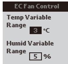
En outre, définissez la GAMME VARIABLE ADJUSTABLE pour votre température et votre humidité dans l'onglet Paramètres du ventilateur EC. Lorsque les paramètres définis sont dépassés, le ventilateur commence à fonctionner à la vitesse maximale définie par l'utilisateur dans les paramètres F1, puis revient progressivement à la vitesse minimale définie par l'utilisateur, de manière linéaire.
