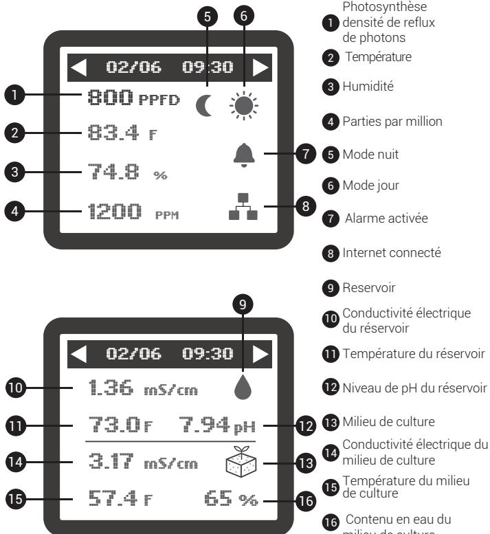
Le symbole d'alarme n'apparaît que lorsqu'une alarme est activée. Le symbole internet n'apparaît que lorsqu'il y a une connectivité internet.
