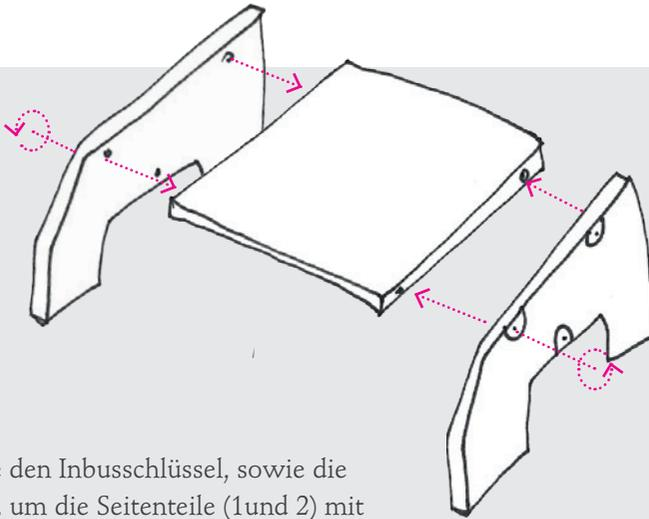
Nutzen Sie den Inbusschlüssel, sowie die Schrauben, um die Seitenteile (1 und 2) mit der Trittplatte (3) zu verbinden.
