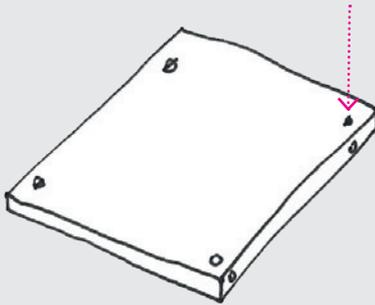
Stecken Sie 4 Quermutterbolzen in die dafür vorgesehenen Bohrungen der Platte (2).
