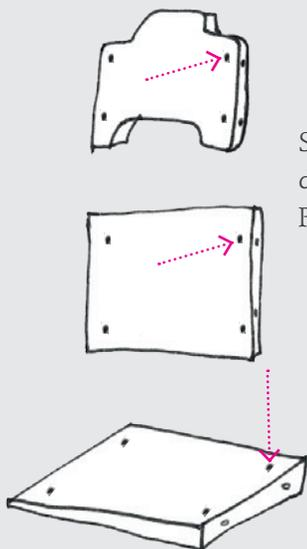
Stecken Sie die 16 Quermutterbolzen in die dafür vorgesehenen Bohrungen der Platten 3, 4, 5 und 6.
