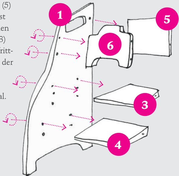
Die Quermutterbolzen befinden sich nach der Montage an den Unterseiten der Platten und sind nicht zu sehen. Bitte beachten Sie, dass die Seitenteile mit den Ausfräsungen um die Schraublöcher nach außen zeigen.
