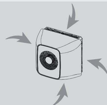
L'MPCJ deve essere installato lontano da ostacoli per consentire alle prese d'aria sui lati di ripescare l'aria della cantina per un ottimo funzionamento
