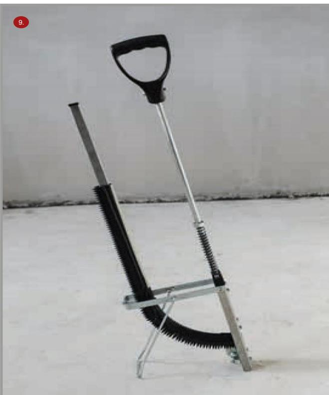
Das Tacker-Montagegerät sollte immer ausreichend mit Rohrhaltern bestückt sein, damit die Rohrhalter sicher in den Schußkopf des Geräts nachrutschen können.
