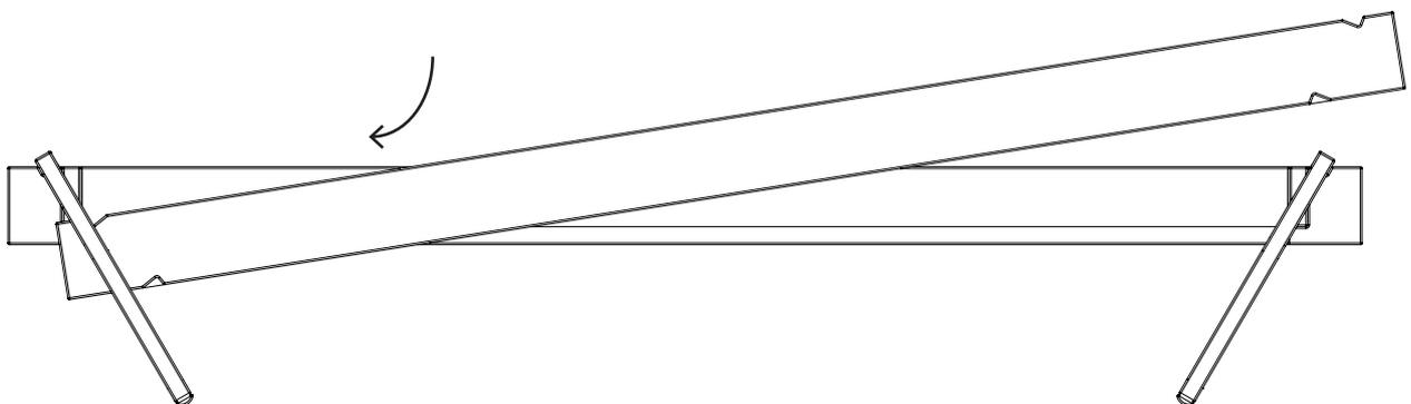
Nehmen Sie die **zweite Wange** (der Stahlwinkel zeigt nach unten und ist nach innen gerichtet) und fädeln Sie die Wange so auf den Fußrahmen auf, dass sich die Ausfräsung der Wange in den Fußrahmen fügt. Korrigieren Sie gegebenenfalls den rechten Winkel wie in Schritt 2 beschrieben.
