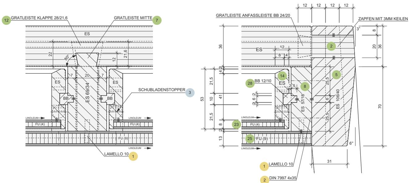
Frontalschnitte: Gratleisten und gegratete Querfriese bilden mit der Platte eine konstruktive Einheit
