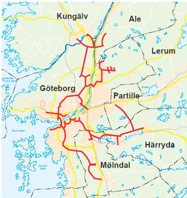
Figur 2. Grynaabs ägarkommuner och upptagningsområde, år 2005. Lerum är ännu inte anslutet. De röda strecken markerar tunnlar och huvudledningar för avloppsvatten. De svarta sträcken markerar kommungränser. De gula strecken markerar större vägar.
