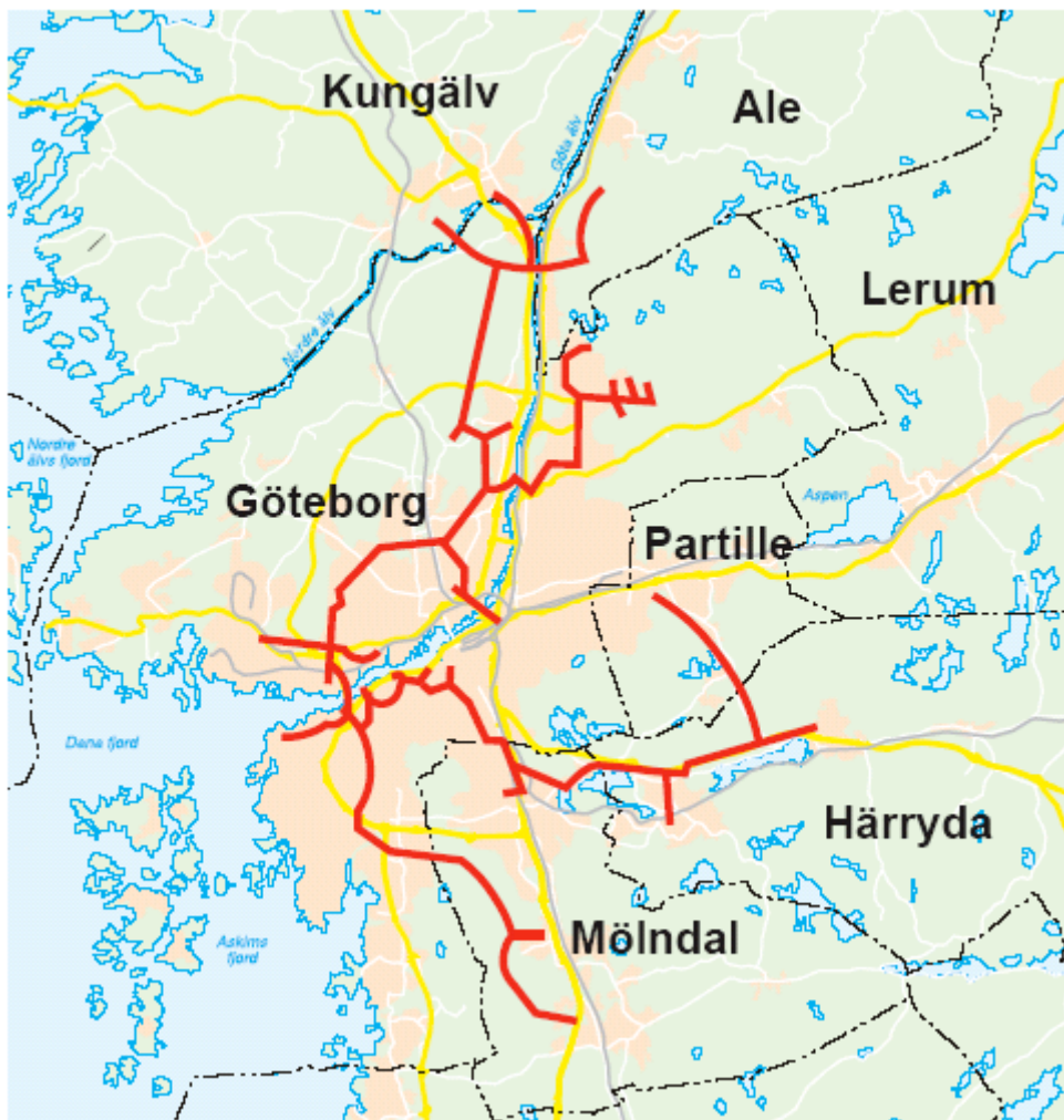
Figur 2-1. Gryaabs ägarkommuner och upptagningsområde, år 2005. Lerum är ännu inte anslutet. De röda strecken markerar tunnlar och huvudledning för avloppsvatten. De svarta sträcken markerar kommungränser. De gula strecken markerar större vägar.
