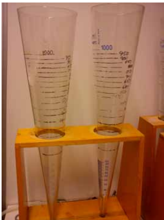
Figur 5-1. Uppställning för sedimentationsförsök.
