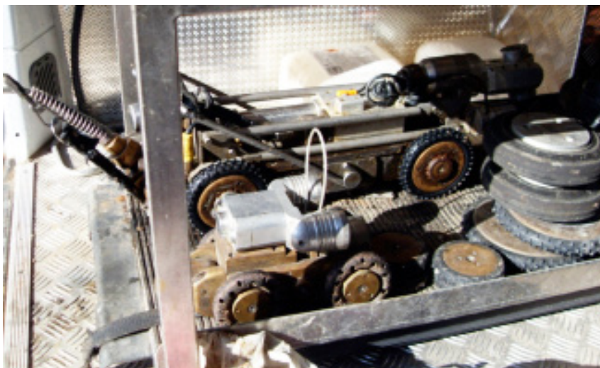
Figur 3-6 Kameravagnarna som användes för att utföra inspektionerna, den mindre (TC 107) närmast i bild och den större (TC 125) strax bakom.
