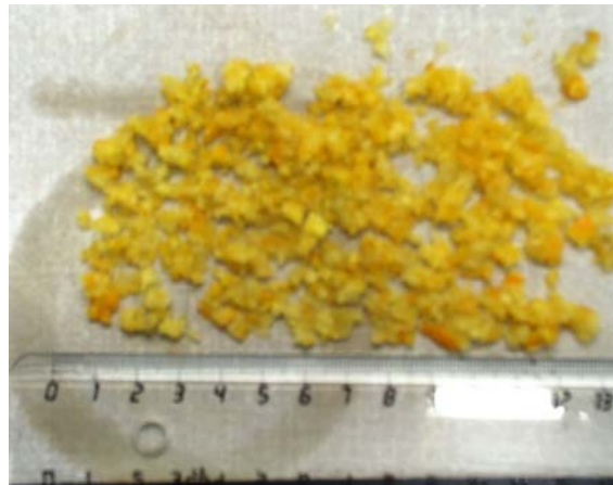
Figur B7.16 Malda apelsinskal med en medelstorlek på 2 millimeter.
