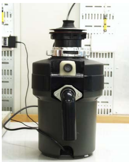
Figur 5.2 Försöksuppställning vid malförsök för att undersöka det malda matavfallets partikelstorlek.
