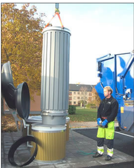
Figur 3.3 - Hämtning av organiskt avfall från Molok. Behållaren längst ned innehåller lakvatten (Molok, 2006).
