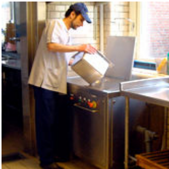
Figur 4.1 – Inmatning av bioavfall i en avfallskvarn med förvaring (Envac, 2006).
