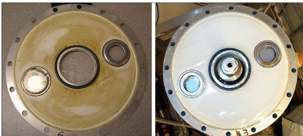
Figur 10.10 Typisk syn av en membranplatta efter körning utan syradosering (tv) och med syradosering (th).
