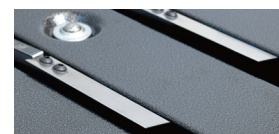
Anslagsfingrar av fjäderstål
