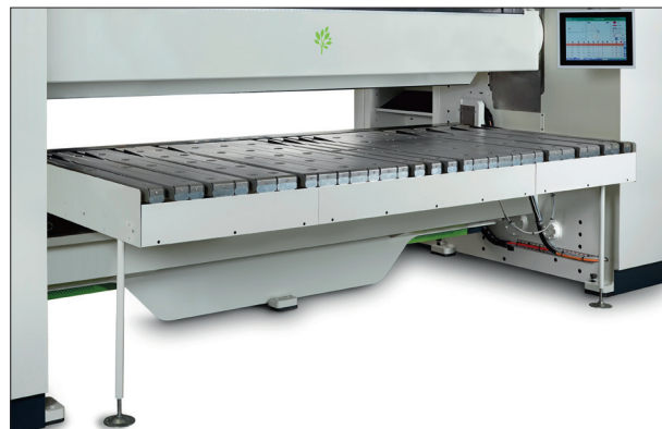
AGS anslagsbord levereras som standard med upp till 16 stycken anslagskenor, beroende på maskinens längd. Fler anslagskenor finns som tillval till AGS med flyttbara anslagskenor.
