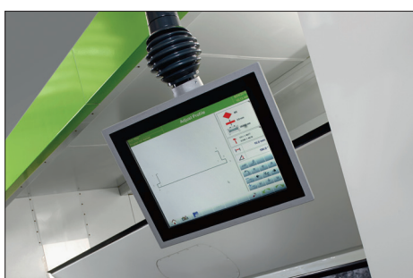
ProLink W styrsystem på en svängbar arm, för att kunna bocka från båda sidor
