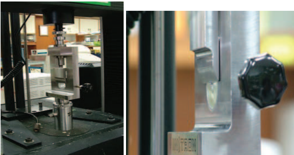
รูปที่ 4 และ 5 แสดงการทดสอบความแข็งแรงพันธะเฉือนด้วยเครื่องทดสอบแรงดึงแรงอัดระบบไฮดรอลิก
