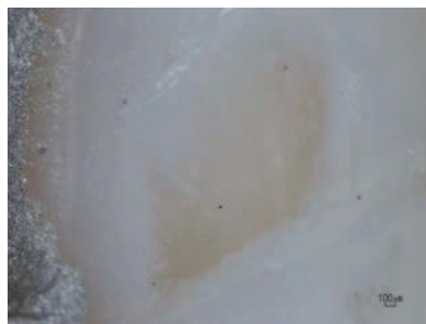
รูปที่ 6 แสดงชิ้นงานที่มีเกิดการแตกหักในชั้นเคลือบฟันที่ บริเวณ E คือส่วนของเคลือบฟัน
