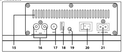
15 Belüftungsöffnungen 16 AUX (R/L) AUX-Anschluss: 2x Cinch Antennenanschluss 75 Ohm 17 ANT. **18 USB** nur für Service: USB-Anschluss
