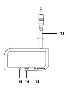
12 Kabel zum Anschließen des Senders an eine Tonquelle (ca. 0,2 m lang, 3,5 mm Klinkenstecker)
