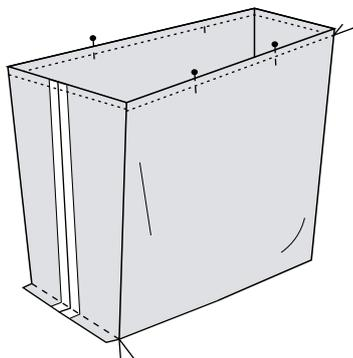
Introduire la doublure dans le sac, endroit contre endroit. Assembler la doublure et le sac par le haut, épingler et coudre.
