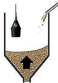
**Pendant le remplissage, le détecteur de niveau est suspendu à la verticale.**
