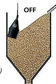
**Lorsque le niveau haut est atteint, le détecteur de niveau s'incline et arrête le remplissage**
