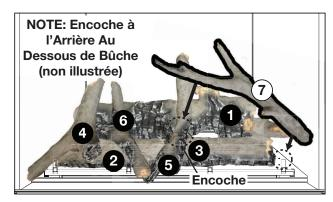
7. Placez le côté gauche de bûche n° 7 dans l'encoche dans bûche n° 5. Restez l'encoche arrière dans bûche n° 7 sur la tige de chenet quatrième.
