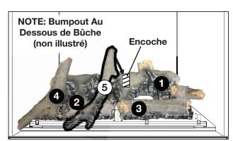
5. Placez le bumpout dans bûche n° 5 dans l'encoche dans bûche n° 1, en reposant l'extrémité opposé le longue du chenet avant.
