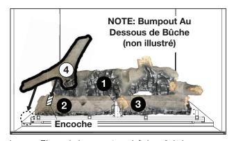
4. Placez le bumpout sur bûche n° 4 dans l'encoche dans bûche n° 2, en reposant l'extrémité opposé à côté de la tige de chenet première.
